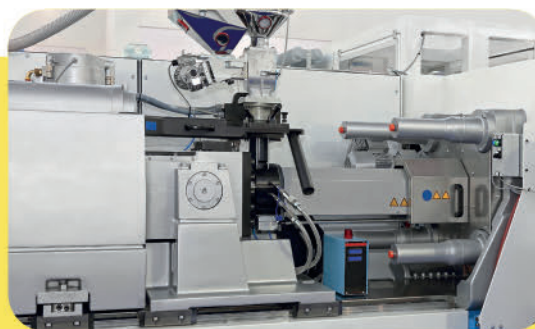
Lubrification de guides en injection plastique.
